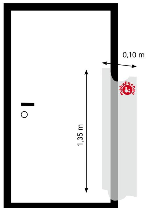
Das Anbringen des Klemmschutzes erfolgt bandseitig auf Türblatt und Türzarge bei geschlossener Tür.
