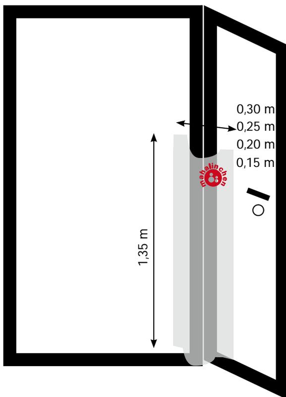
Das Anbringen des Klemmschutzes erfolgt auf Türblatt und Türzarge bei maximal geöffneter Tür.
